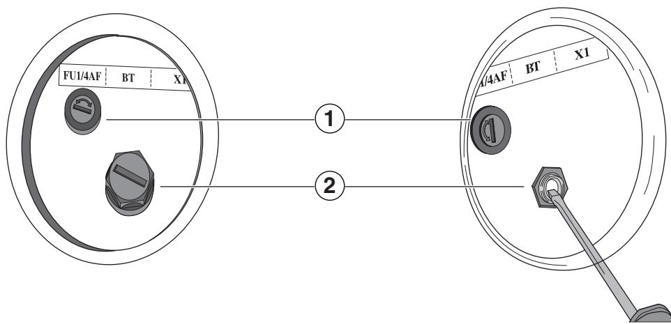
Рис. 37 Разблокировка предохранительного ограничителя температуры
