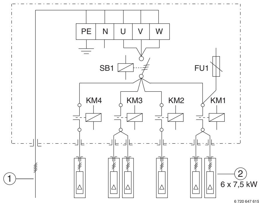
Рис. 21 Электрическая схема Logamax E213 45
