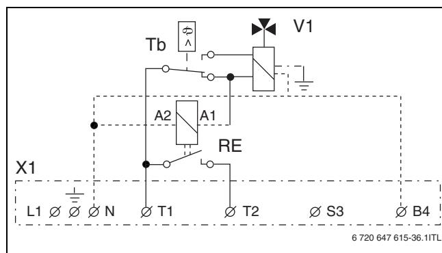
Рис. 33 Трёхходовой клапан регулируется переключающим контактом X1
