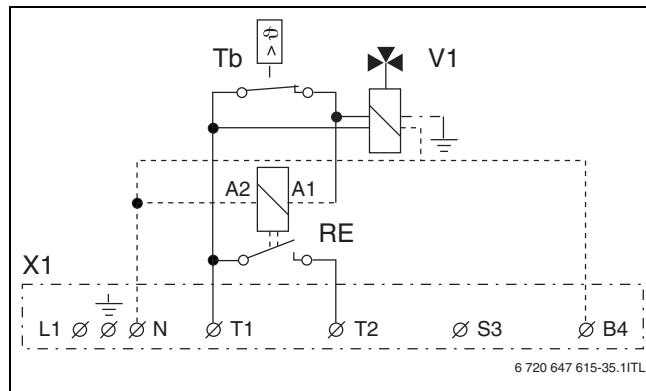
Рис. 32 Трёхходовой клапан с питанием от контакта X1
