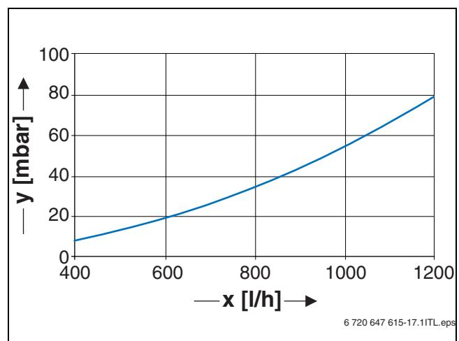
Рис. 42 Гидравлическое сопротивление Logamax E213 4 – 18
