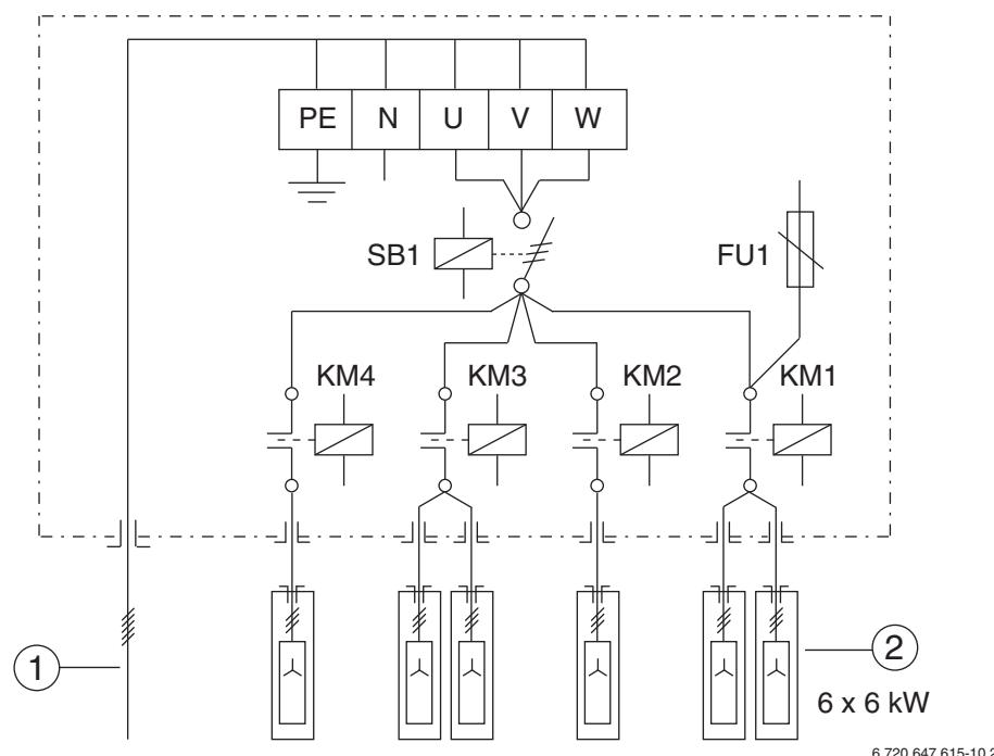
Рис. 20 Электрическая схема Logamax E213 36
