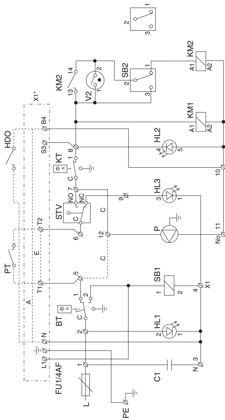
Рис. 13 Электрическая схема Logamax E213 4–8 (пояснение условных обозначений → стр. 18)
