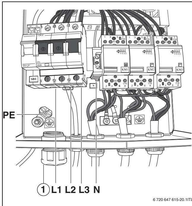
Рис. 7 Подключение сетевого провода 4–30 кВт (5-проводная сеть)
