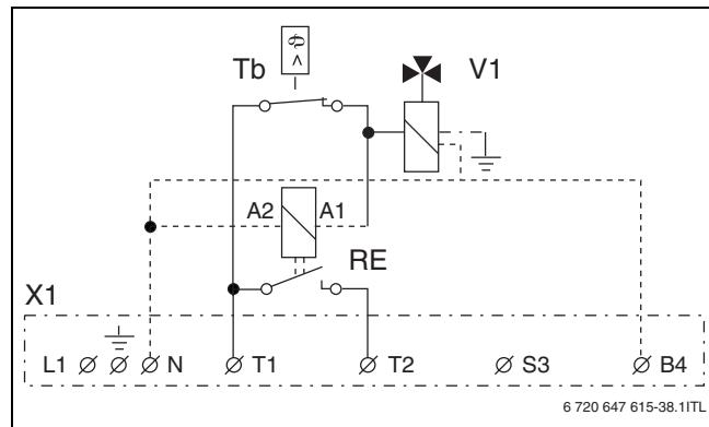
Рис. 35 Трёхходовой клапан регулируется замыкающим контактом X1
