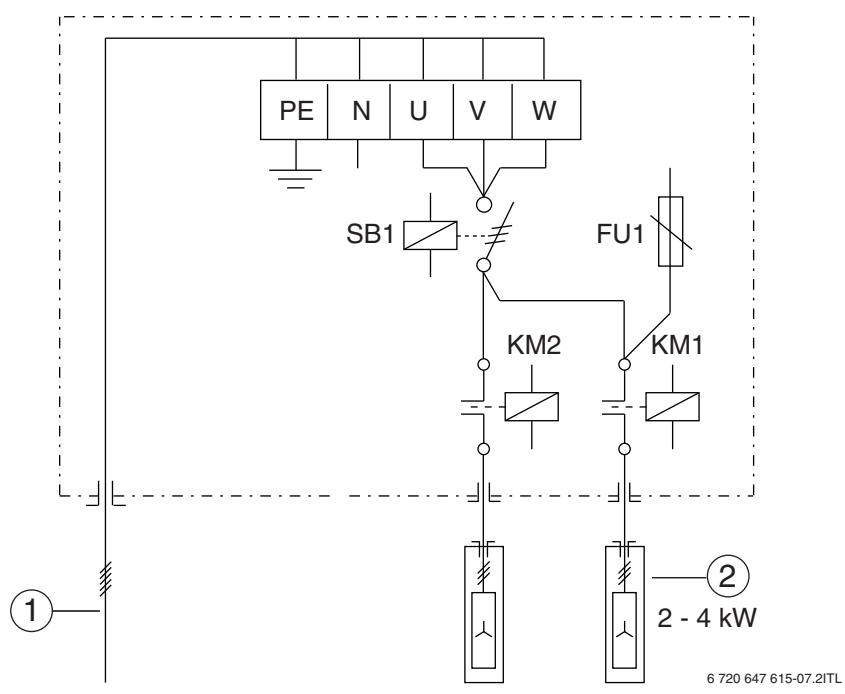
Рис. 17 Электрическая схема Logamax E213 4–8
