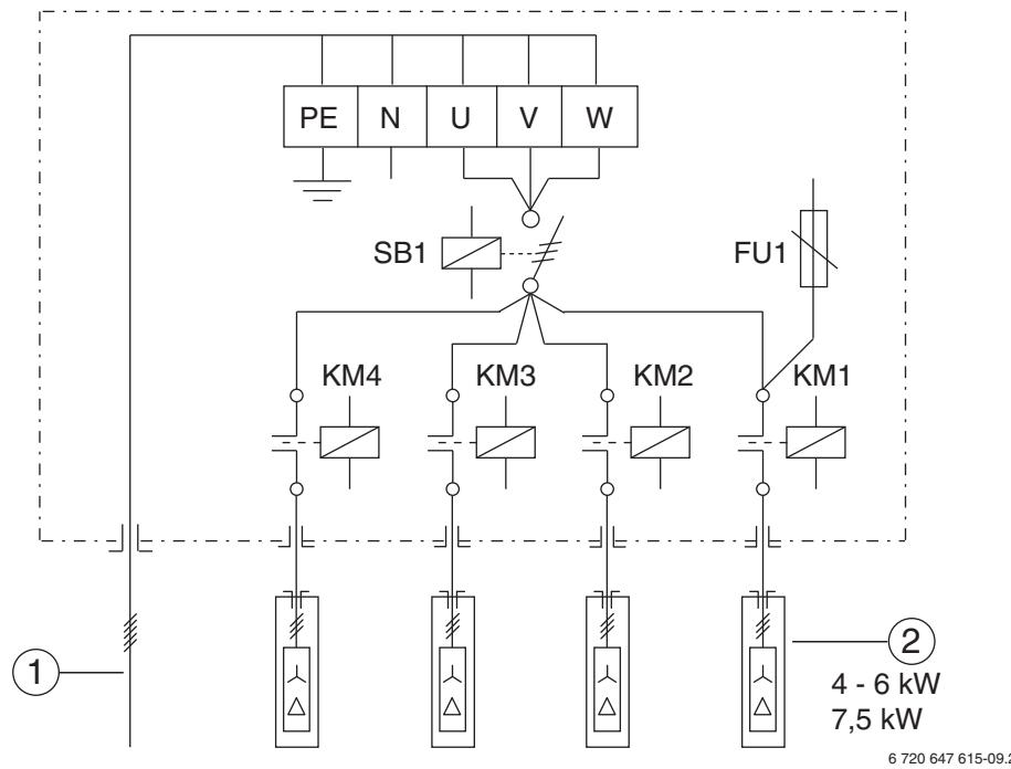
Рис. 19 Электрическая схема Logamax E213 22 – 30
