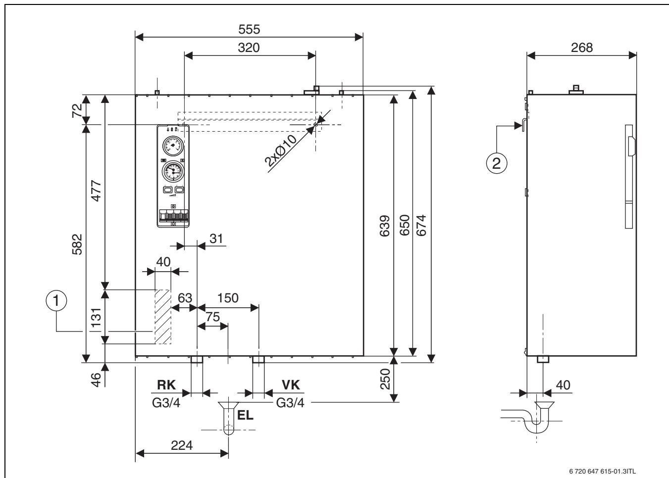
Рис. 2 Размеры и подключения Logamax E213 4–18
