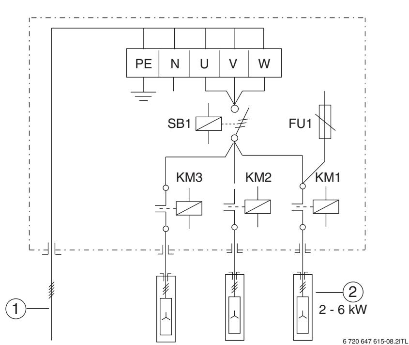
Рис. 18 Электрическая схема Logamax E213 10–18
