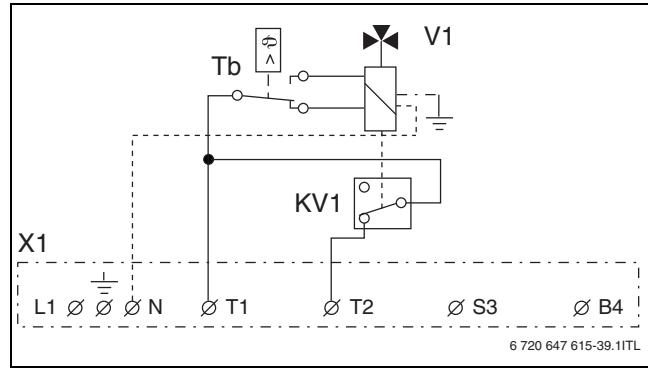
Рис. 36 Трёхходовой клапан со вспомогательным контактом KV1
