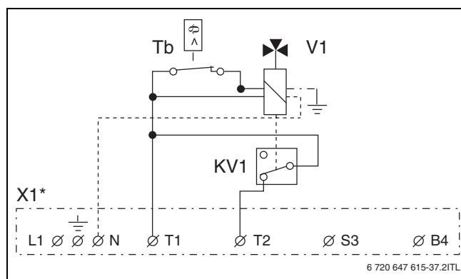
Рис. 34 Трёхходовой клапан со вспомогательным контактом KV1
