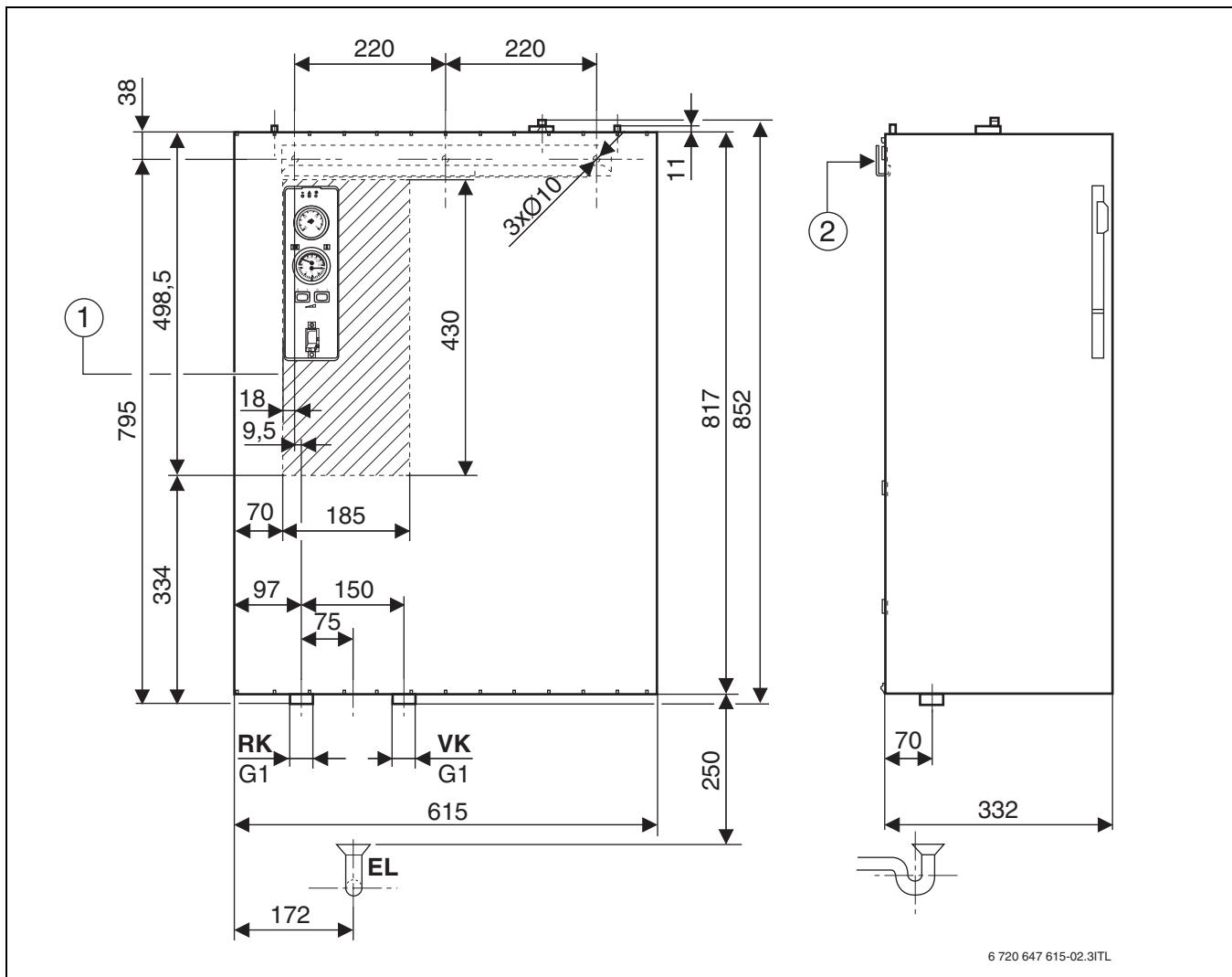
Рис. 3 Размеры и подключения Logamax E213 22–60
