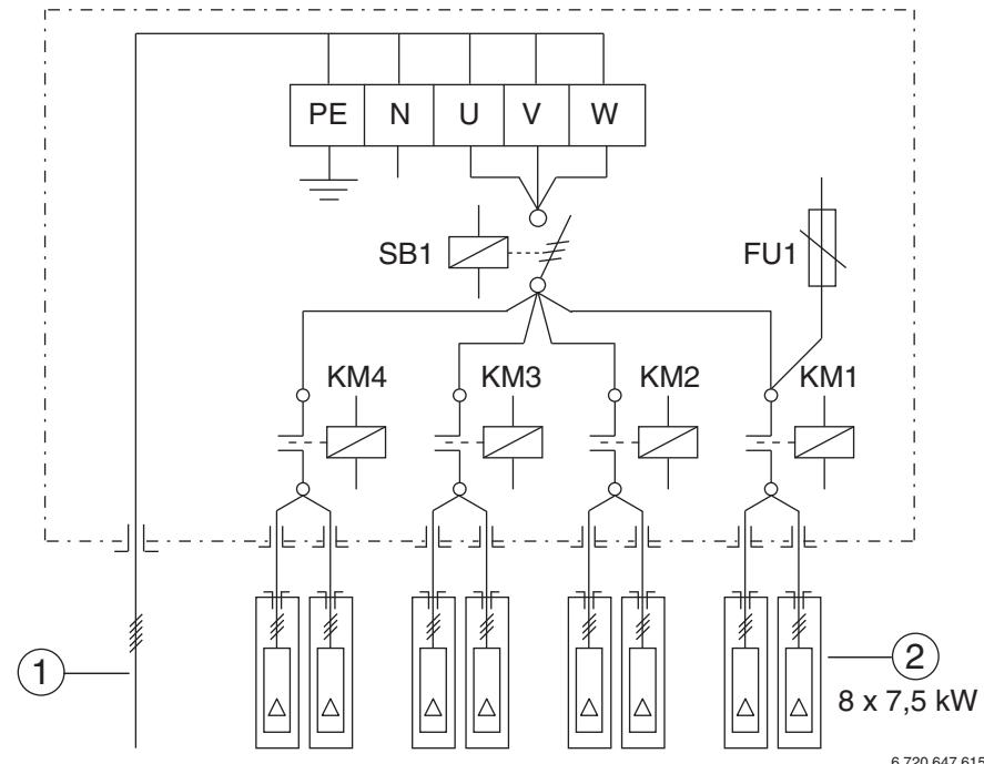
Рис. 22 Электрическая схема Logamax E213 60
