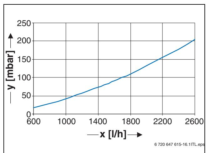
Рис. 41 Гидравлическое сопротивление Logamax E213 22 – 60
