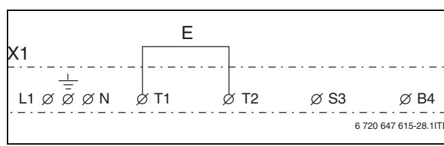
Рис. 28 Включение котла без комнатного регулятора температуры
